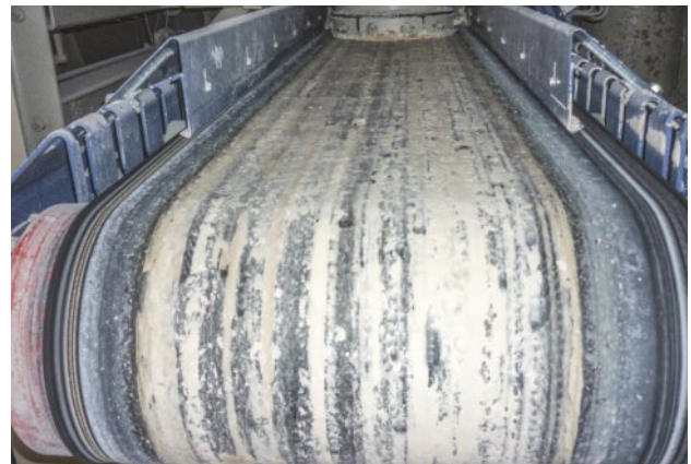
Vorher: Anbackungen am Gurt führen zu Verschmutzung der Umgebung.
