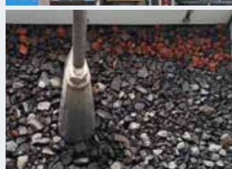
Vue sur le lit de matériau montrant le processus de séparation des bons matériaux (graviers en basalte noir) et les mauvais matériaux (pierre ponce rouge).
