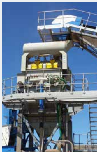
SSS Jig (Séparateur par dépôt, environ 1 200 mm) Site : Hawaï/Oahu Défi particulier : Séparation de pierre ponce rouge à extraire de graviers en basalte noir. Ce n'est qu'après avoir utilisé un séparateur par dépôt que l'on a pu obtenir de très bons résultats au niveau des matériaux : Granulométrie : 6 – 38 mm avec un débit de transfert de 80 à 100 t/h.
