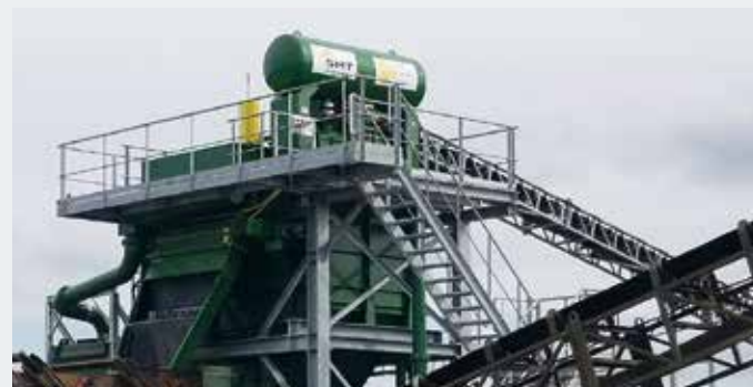
Séparateur par dépôt type 2500 SG, Site : Danemark Puissance 170 t/h, granulométrie 2 – 32 mm Séparation de composants nuisibles au béton. Les matériaux légers sont évacués par le biais d'un crible de drainage et amenés sur le terri.
