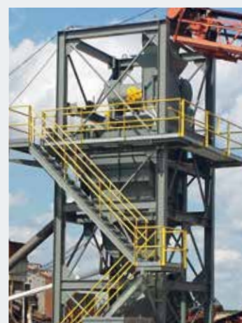
SSS Jig (Séparateur par dépôt, environ 2 500 mm) Site : USA, Dakota du Sud Défi particulier : Séparation d'ardoise et d'oxyde de fer, à extraire difficilement de gisements de sable. Le séparateur par dépôt atteint des données au-dessous de 6%.
