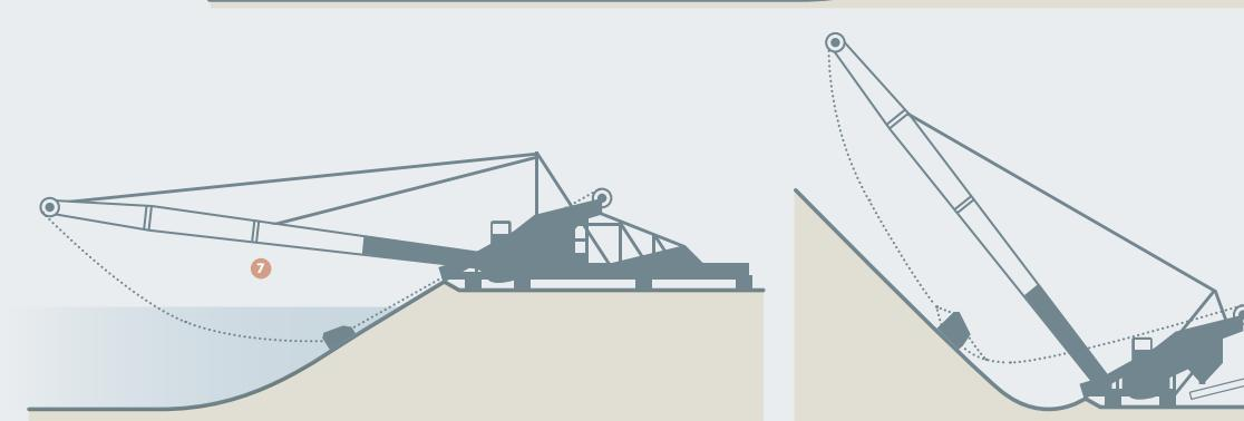
1 Scraper 2 Godet 3 Poulie fixe de renvoi 4 Poulie flottante de renvoi 5 Câble de retour 6 Câble de traction en avant 7 Flèche
