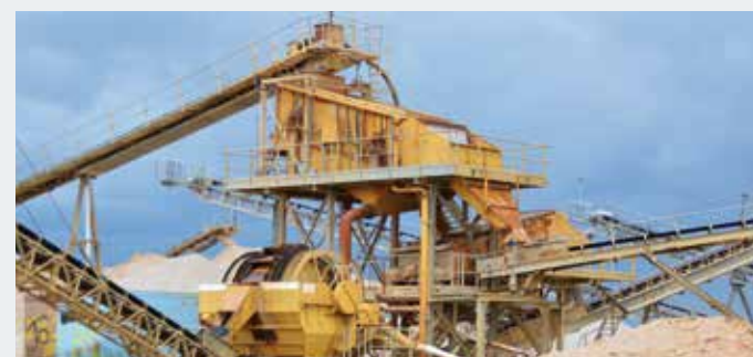
Usine de traitement STICHWEH avec CRIBLEUSE À DEUX ÉTAGES VS 24/60 Laveur à pales double DSW 150/2100/6000 Roue à godets ES 3509 BB
