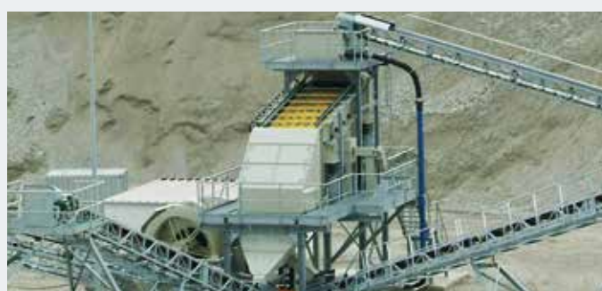
Usine de traitement STICHWEH avec CRIBLEUSE À UN ÉTAGE VS 15/40 CRIBLEUSE À TROIS ÉTAGES VS 18/60 Roue à godets ES 3009 BB
