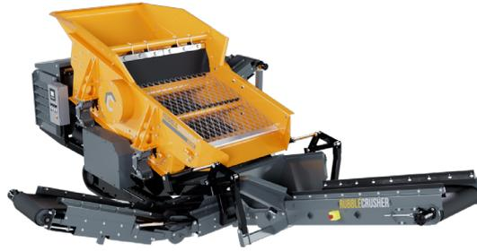
Ausgestattet mit drei ausklappbaren Austragbändern, erlaubt die RC-S48 Siebanlage die Trennung in bis zu drei verschiedene Fraktionen: 25 mm (1"), 12,5–25 mm (1/2-1") und unter 12,5 mm (1/2"). Über den großen eingebauten Beschickungstrichter können Sie Ihr Material problemlos mittels Minibagger oder Kompaktlader aufgeben.
